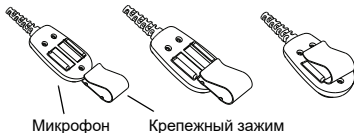
Рисунок 1. Установка на солнцезащитный козырек
